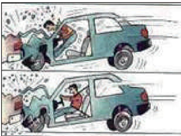
Em caso de colisão traseira, “os protetores de cabeça, controlados por sensores, são movidos para frente para proporcionar proteção para a cabeça do motorista e do passageiro dianteiro dentro de “milésimos de segundos”. Os protetores [...] previnem que a coluna vertebral se dobre, em caso de acidente, reduzindo o risco de ferimentos devido ao efeito chicote (a cabeça é forçada para trás e, em seguida, volta rápido para frente)”.
