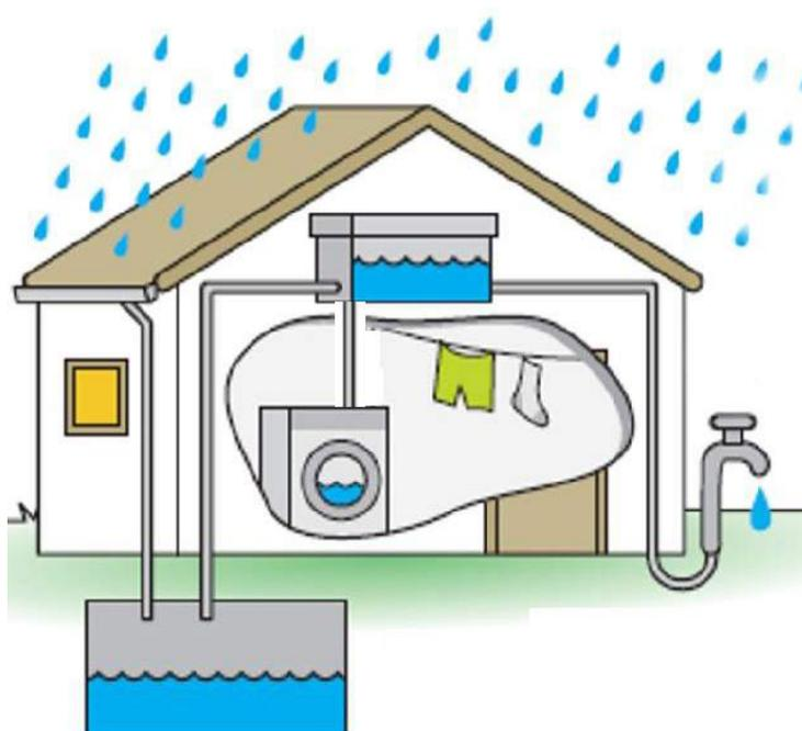
DA CALHA, A ÁGUA SEGUE POR UM TUBO CONDUTOR ATÉ O RESERVATÓRIO DE TRATAMENTO, ENTERRADO NO CHÃO. DELE O LÍQUIDO SEGUE PARA O RESERVATÓRIO SOB O TELHADO, DO QUAL É DISTRIBUÍDO.
